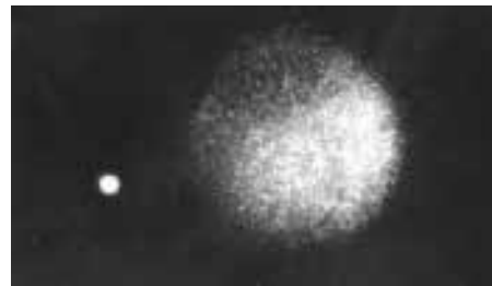
照片12.2 在油中加热的聚乙烯粒子 左侧的小白点是加热前聚乙烯粒子的大小。
